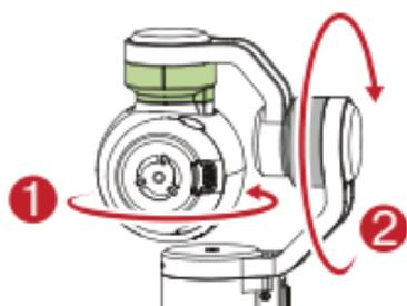
1. Поверните двигатель оси наклона.
